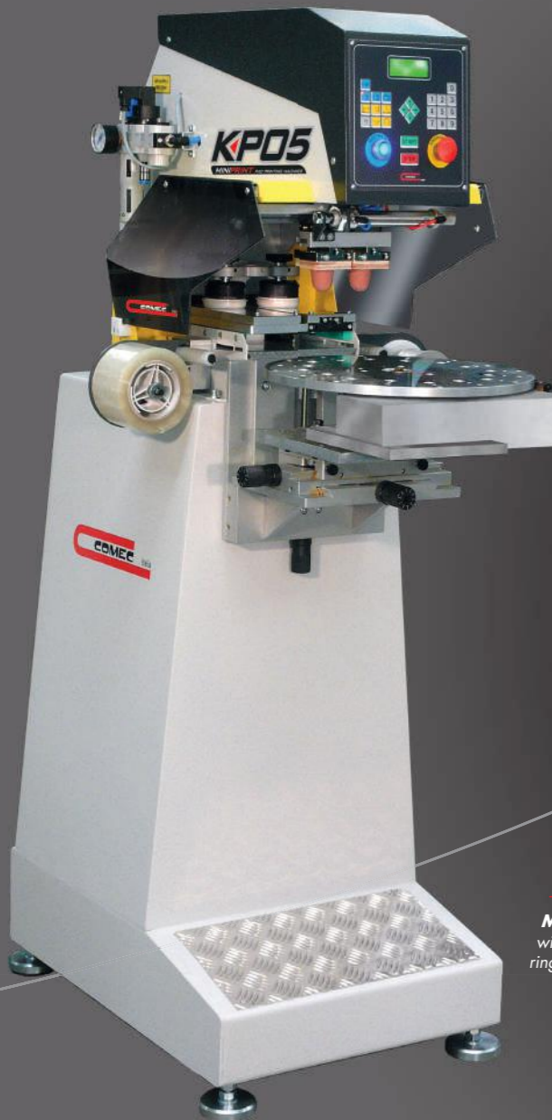
MINIPRINT KP05 2C RR con calamaio ermetico ed anello in ceramica Ø 70mm, e tavola rotante
